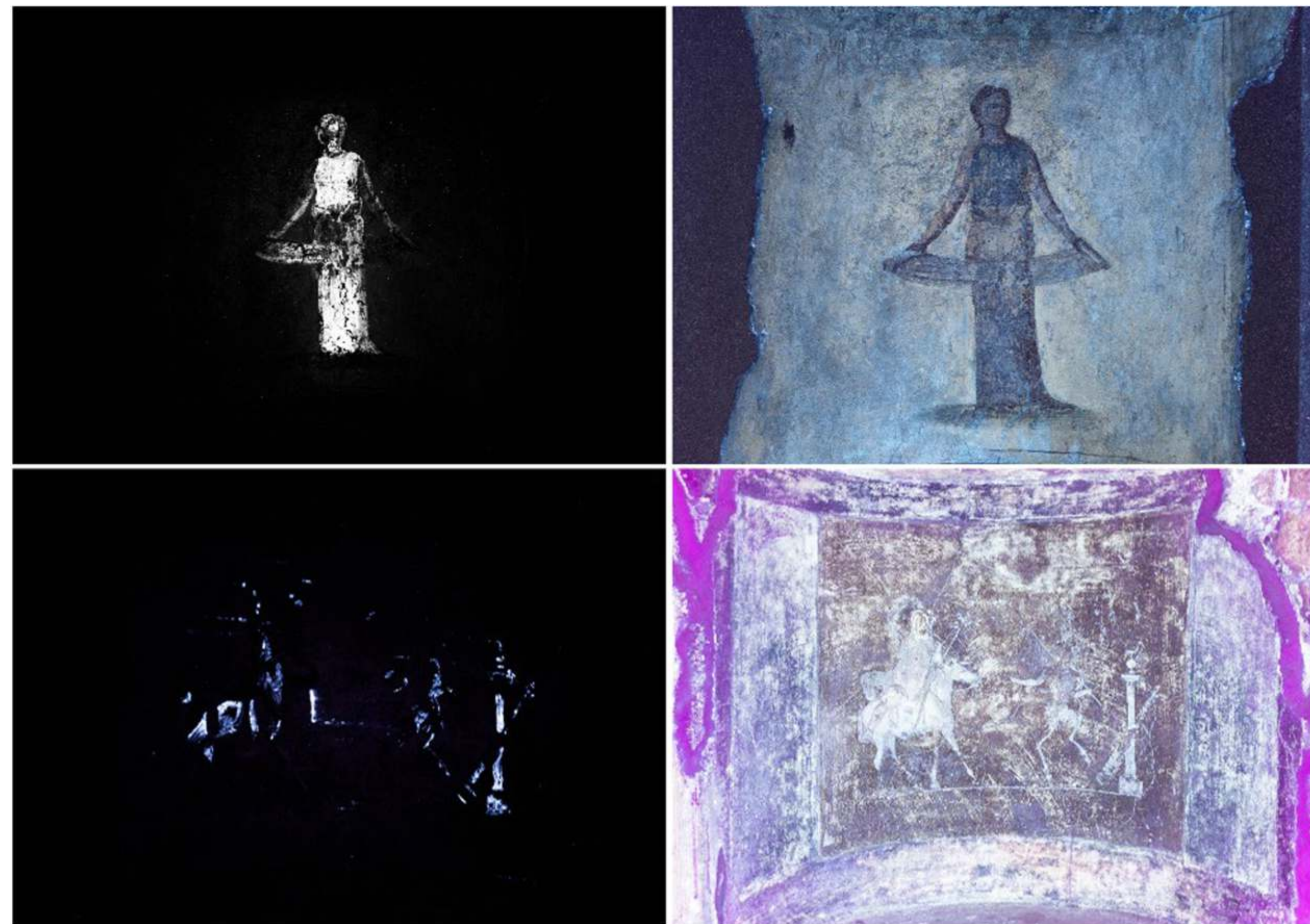
Fig. 2 a) Luminescenza VIL affresco tomba 11; b) Fluorescenza ultravioletta (UV) affresco tomba 11; c) Luminescenza VIL affresco tomba 16; d) Fluorescenza ultravioletta (UV) affresco tomba 16.
